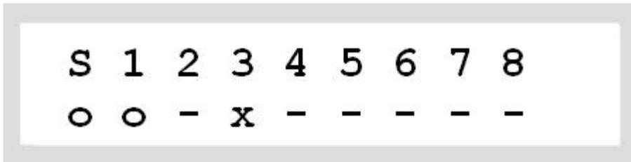
如上图所示，结果为 1 号硬盘复制成功，3 号硬盘复制失败，2/4/5/6/7/8 号端口没有插入硬盘。
